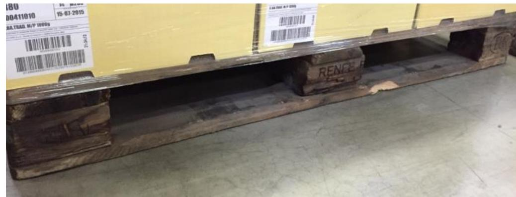
*Evidente stato di usura dei pallet con legno sporco ed umido*
