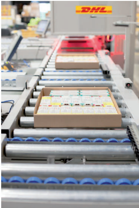
Figura 46: Sistema di rilevazione codici e bollino ottico con tecnologia imaging. (Immagine a cortesia di DHL Supply Chain).
