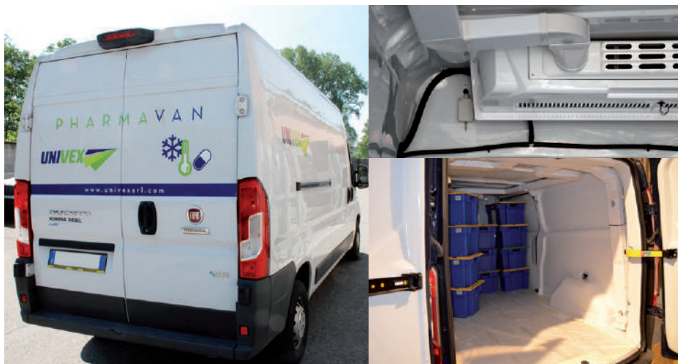
Figura 28: Esempio di mezzo per il trasporto secondario – vista posteriore, carico per le farmacie, e dettaglio evaporatore con sonda temperatura. (Immagine a cortesia di Univex).
